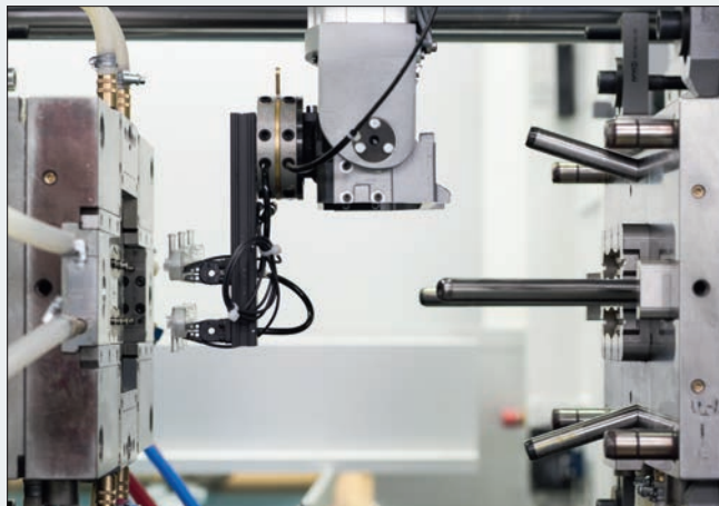
Handlingentnahme mit direkter Platzierung auf Trays oder Weitertransport zur Montage in den Reinraum
