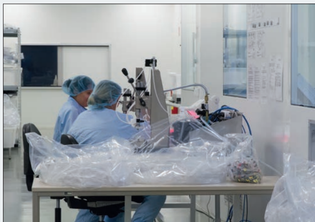
Arbeitsplatz zur Handmontage im Reinraum Klasse 7
