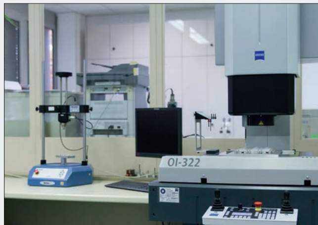
Klimatisiertes Messlabor mit taktilem und optischem Messgerät sowie Messgerät zur Drehmomentprüfung
