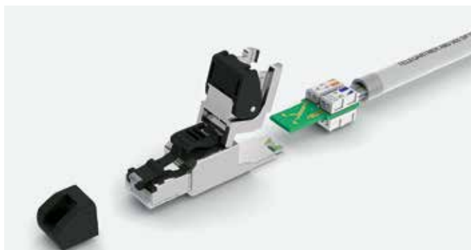
Beispiel für einen feldkonfektionierbaren RJ45-Stecker (Telegärtner MFP8), mit dem Geräte wie Switche und Server direkt über das Verlegekabel miteinander verbunden werden können (Direct Connect).
