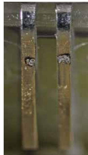
Bei einem Ausstecken des Geräts mit PoE+ im laufenden Betrieb entstehen Abreißfunken, die die feinen Kontakte der RJ45-Steckverbindung beschädigen.
