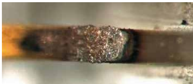
Bei einem Ausstecken des Geräts mit PoE+ im laufenden Betrieb entstehen Abreißfunken, die die feinen Kontakte der RJ45-Steckverbindung beschädigen.
